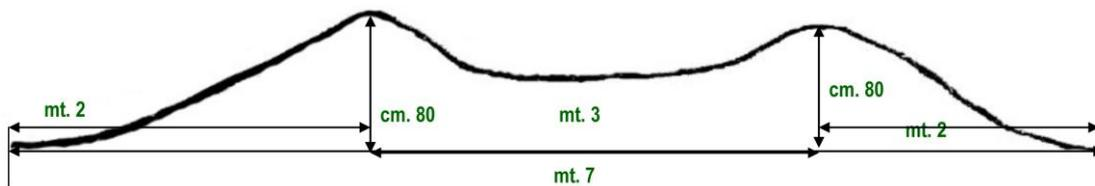
La sua lunghezza complessiva è di metri **7** la distanza degli apici delle due cunette sul dosso è di metri **3** come quella della parte centrale superiore e pianeggiante del dosso che è alta **cm.50** mentre le due cunette sono alte **cm.80**
