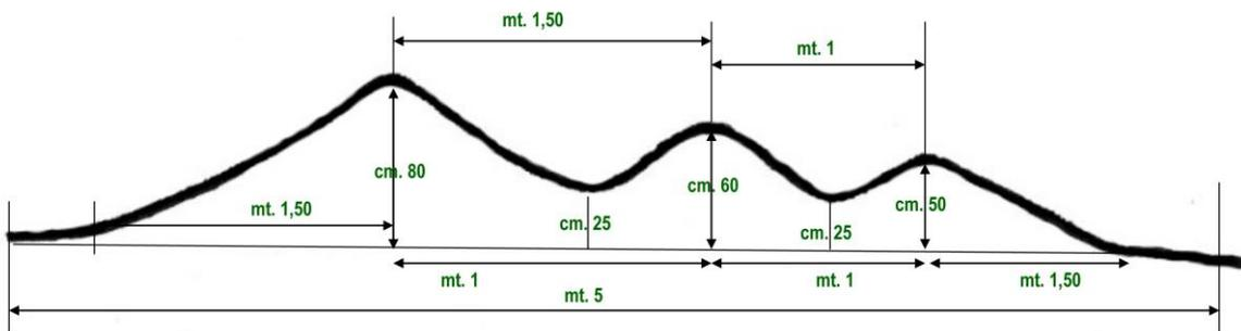
Il primo salto è alto **cm.80** e lungo metri **2,50** in **LT (linea di terra)** con la salita che termina a metri **1,50** su **LT** e la discesa che inizia a metri **1,50** su **LT** e termina a metri **1** dall'apice della salita.
