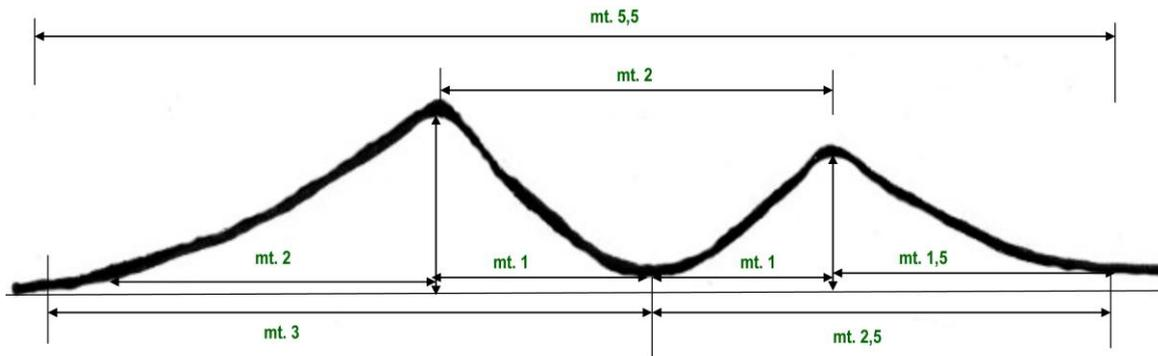
Il primo dei due salti è alto **cm.80** il suo apice dista metri **2** da quello del seguente alto **cm.60** Il primo salto è lungo complessivamente metri **3** sulla **LT** e ha a salita lunga il **doppio** della sua discesa per slanciare meglio il pilota in lungo e non in alto (vedere schema dei salti visti in sezione con tutte le misure necessarie per la costruzione di questi)
