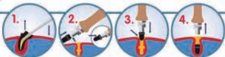
La valvola è **UNIVERSALE** per tutti i palloni Trial. Prodotta in gomma naturale vulcanizzata, **LEGGERRISSIMA** (gr 0,07), per non sbilanciare neppure il pallone più leggero, facilmente **SOSTITUIBILE** con KIT prodotto da Trial. Tutti i palloni sono rigonfiabili usando il classico ago a punta arrotondata. Il rigonfiaggio deve avvenire con l'opportuna diligenza e nel rispetto delle pressioni indicate per ciascun pallone.
