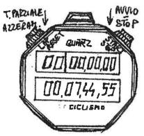
RIALLINEAMENTO: premere una seconda volta il pulsante LAP, riappare il tempo base;
