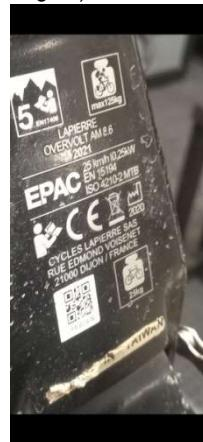
poiché conformi con la direttiva 2002/24 che regola le caratteristiche del velocipede avente motore elettrico con la potenza nominale continua massima di 250W , inoltre l'assistenza deve essere rilasciata grazie e solo alla rotazione delle pedivelle (si può mettere l'extender della batteria purché non fatto in casa)
