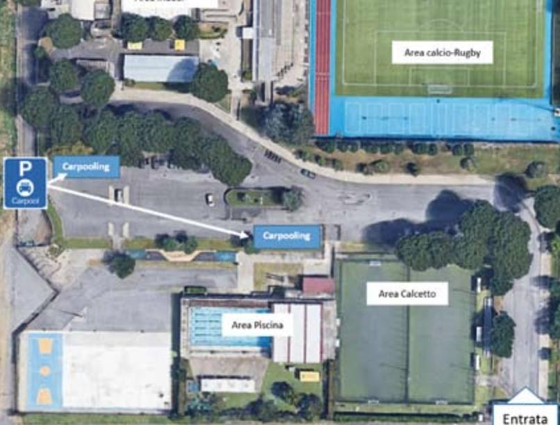
I ipotesi di collocazione delle aree di sosta: 18 posti auto di tipo standard. (2,5 m x 5).
